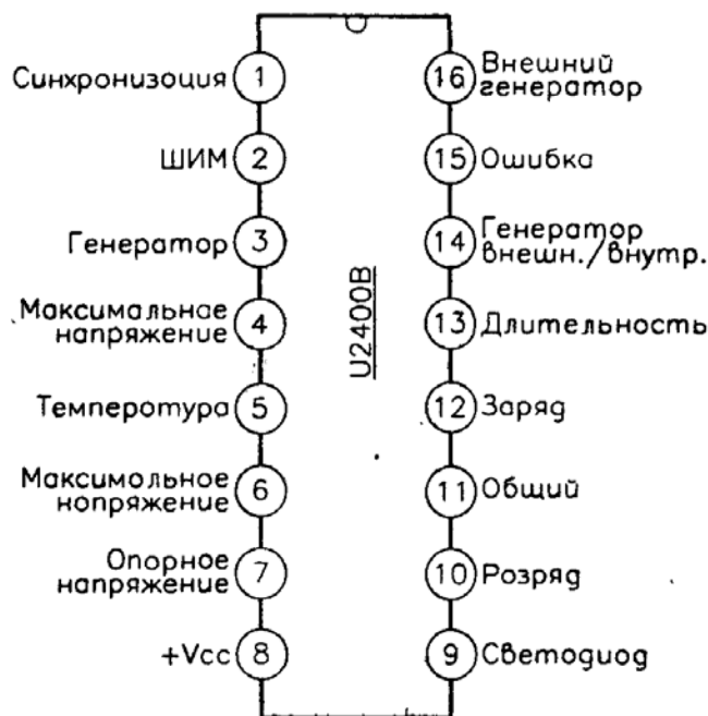
Рис. 5.5. Расположение выводов интегральной схемы U2400B
